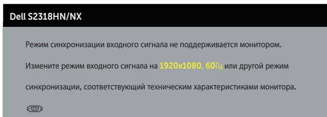
Это означает, что монитор не может произвести синхронизацию с получаемым от компьютера сигналом. Информацию о диапазонах частоты строк и кадров, применимых к данному монитору, см. в разделе [Технические характеристики монитора](#). Рекомендуется разрешение 1920 x 1080.
